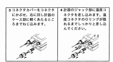
注記 ▶▶▶ 計器がD-25の場合、DO電極の接続部はC2とT2で す。C1、T1はpHまたはORP電極専用です。
